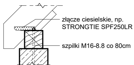
Połączenie krokwi z murłatą
